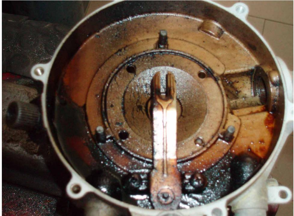
2. E' FACILMENTE VISIBILE L'ELIMINAZIONE DEI RESIUI DALL'APPARATO DOPO APPENA DUE TRATTAMENTI DELL'ADDITIVO GPL-ADDITIVE.
